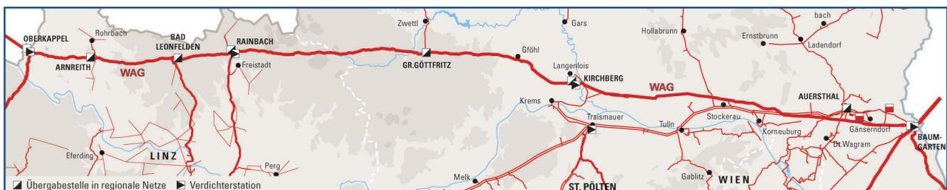
**Fakten zum WAG-Ausbau:** Ziel: Steigerung der Transportkapazität um rund 2 Mrd. m<sup>3</sup>/Jahr ab 2013 | Durchmesser: 1.200 mm | Wandstärke: mind. 16 mm | Betriebsdruck: max. 90 bar | Länge: insgesamt 63 km (3 Abschnitte) | Baubeginn: 2011 in NÖ
