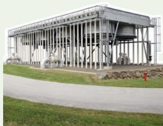
**TROCKNUNG:** In Trocknungskolonnen wird der dabei entstandene Wasserdampf aus dem Gas entfernt. Dies geschieht durch das Glykoltrocknungsverfahren. Glykol ist eine stark Feuchtigkeit aufnehmende Flüssigkeit.
